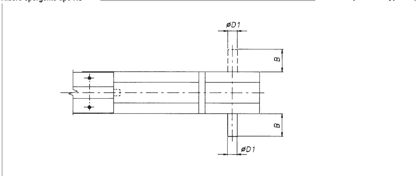
Posizione dell'albero sporgente a destra o a sinistra rispetto alla testata motrice - Position of the simple shaft to the right or to the left of the driving head
