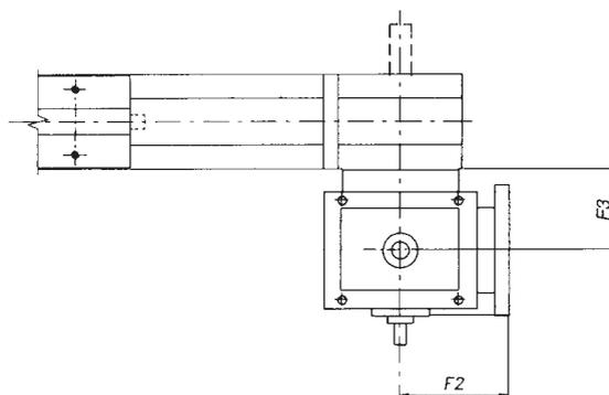
Montaggio riduttore a destra o a sinistra rispetto alla testata motrice.
